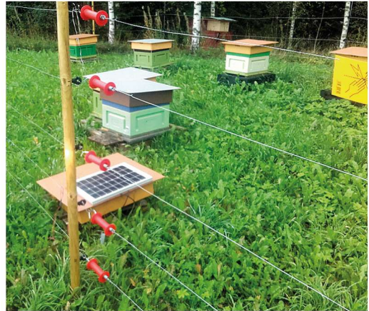
Karukahjude ennetamiseks ehitatud elektritaru on lihtne, töökindel ja tõhus.
